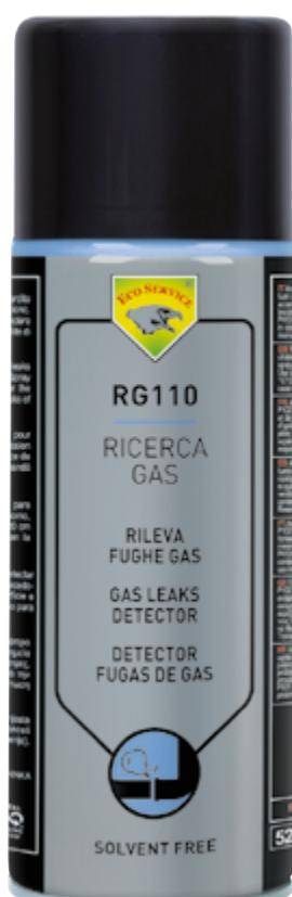
**PT** Detector De Gás é o sistema mais rápido e seguro de detetar fugas de gás em aparelhos sujeitos a pressão (caldeiras, fornos, aquecedores e tubos). Pulverizar o produto a uma distância de 20cm da superfície e esperar pela formação de bolhas em presença de fugas de gás. Óptimo para micro fugas de gás.
