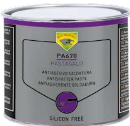
**PT** Pastasald: Anti adesivo soldadura em pasta. Evita que escórias e pingos de soldadura adiram às superfícies. Ideal para manter sempre limpos e a funcionar os bicos dos aparelhos de soldar manuais e automáticos. O produto não contém silicone e, portanto, as partes tratadas podem ser pintadas e zincadas. Modo de utilização: Mergulhar a tocha quente e limpa na pasta, esperar alguns segundos e depois utilizá-la.
